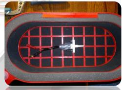
• Eliminazione del recupero vapori olio nel motore, per alimentare il motore solo con aria pulita.
