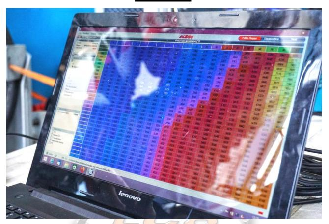
*Tuneecu* è un software gratuito che permette di effettuare operazioni di diagnosi, salvataggio mappature, modifica mappature, modifica dei parametri e dei dispositivi installati lavorando direttamente sulla centralina del motore. E' stato sviluppato e reso disponibile gratuitamente per Ktm, Triumph, Aprilia, Ducati, Guzzi, Benelli e ancora altri marchi.
